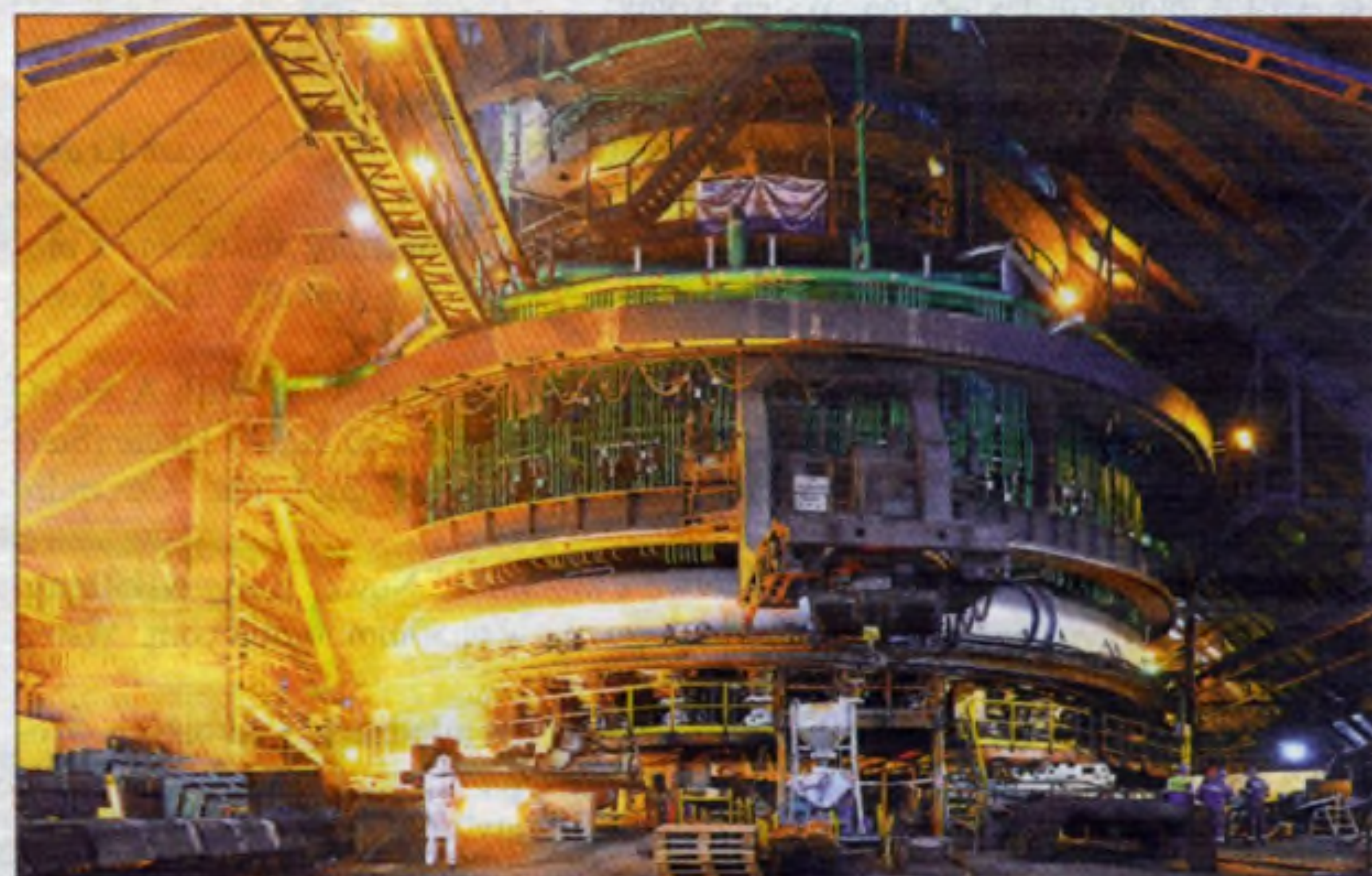
Remont i wymiana nagrzewnic wielkiego pieca pozwoli podnieść temperaturę gorącego dmuchu o około 100 st. Celsjusza, a tym samym zmniejszyć zużycie koksu i emisję zanieczyszczeń do powietrza.
