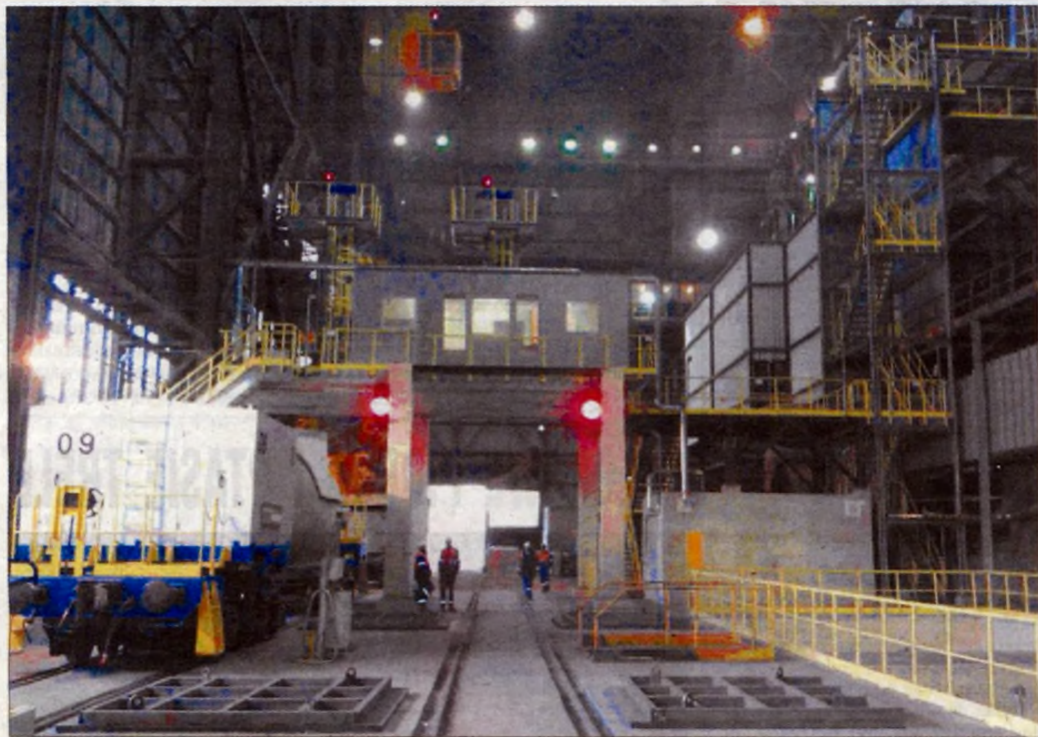
W miejsce mieszalnika została wybudowana stacja przelewania surowki. Niedługo mieszalnik zostanie całkowicie wyłączony.
